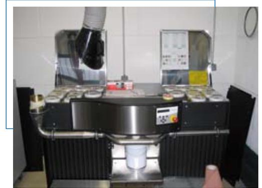
Système d'aspiration des solvants à la source (tête de dosage) avec turbine d'aspiration et flexible à connecter à une évacuation extérieure.
