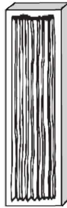
Collage d'isolant en plein pour les tableaux et voussures
