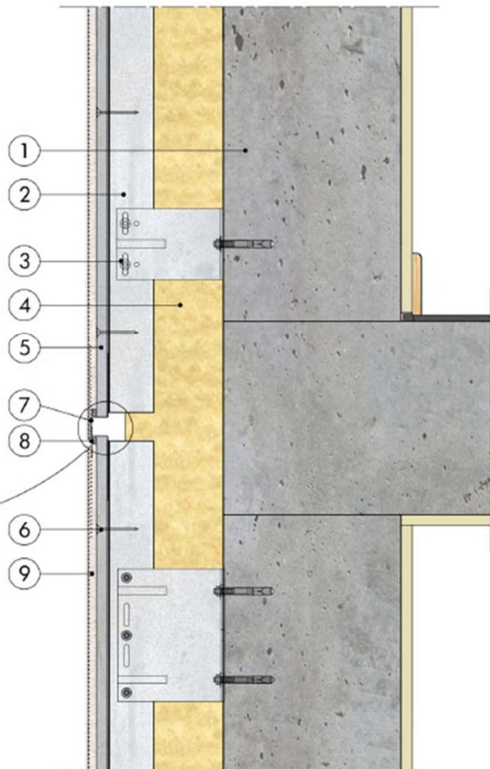
Figure B2 – Détail joint de dilatation de 12 à 15 cm
